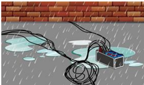
電箱電線未做好防水措施
